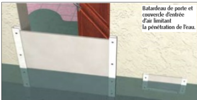
Mise en place d'un batardeau
