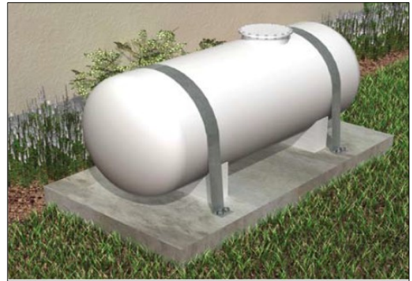
Renforcement du support et ancrage de la cuve
